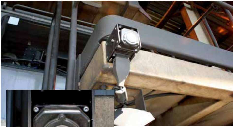
赤外線カメラPathFindIRは採掘トラックの前部に簡単に取り付けられます。
