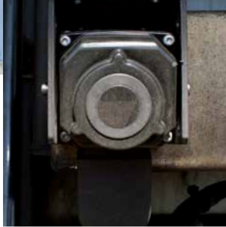
赤外線カメラPathFindIRは採掘トラックの前部に簡単に取り付けられます。
