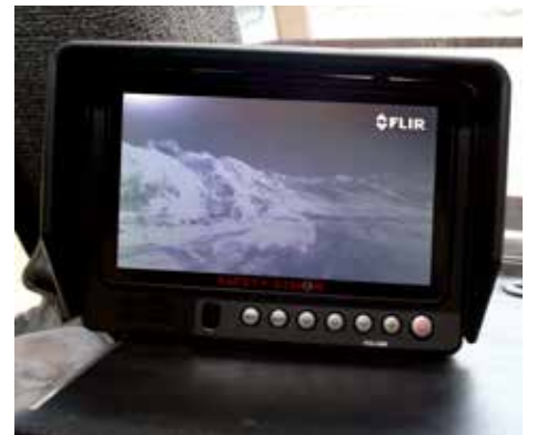
PathFindIRで生成された赤外線画像がトラックのキャビン内の7インチ液晶画面に映し出されています。赤外線画像がドライバーによる事故を回避することを助けています。
